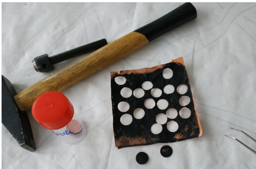
Obrázek 3.5 Vysekané elektrody a nástroje k vysekání elektrod
