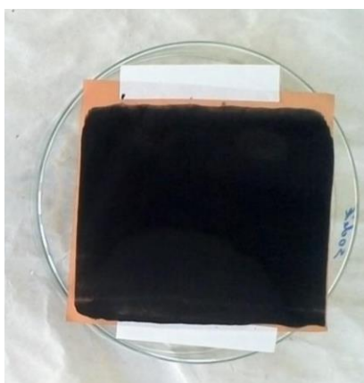
Obrázek 3.3 Elektrodová směs po vysušení [14]
