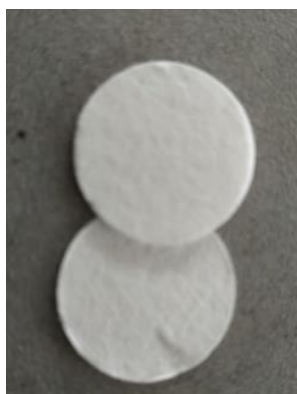
Obrázek 3.9 Separátor o průměru 18 mm [14]
