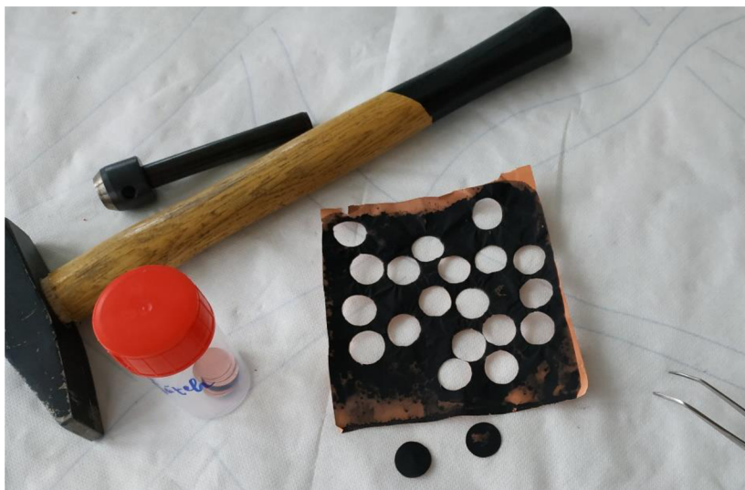
Obrázek 3.5 Vysekané elektrody a nástroje k vysekání elektrod
