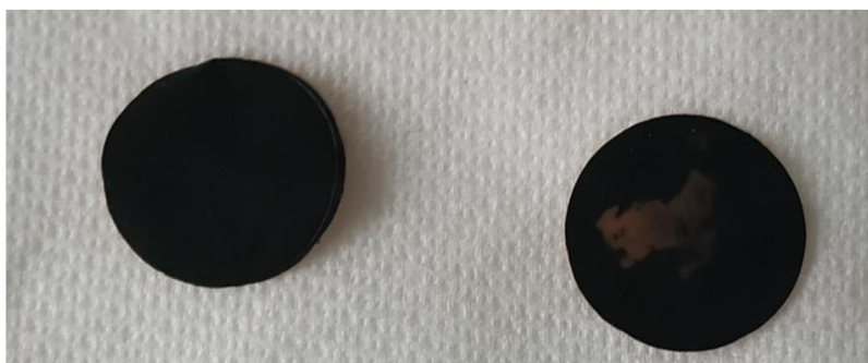
Obrázek 3.6 Špatné elektrody (levá-špatně vyseklá, pravá-opticky špatná)
