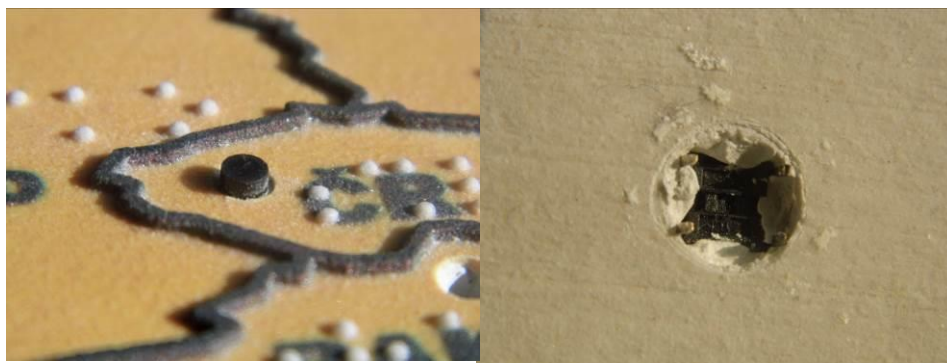
Obr 4.2 Nainstalované tlačítko v tyfloomapě – horní a spodní strana tlačítka
