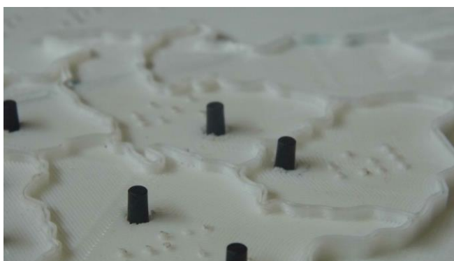
Obr. 11.1 Zabudovaná čidla v nízkonákladové tyflomapě
