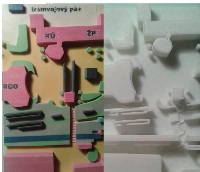
Obr. 5.4 Část tyflomapy přednádražního prostoru – nový výtisk a původní sádrový
