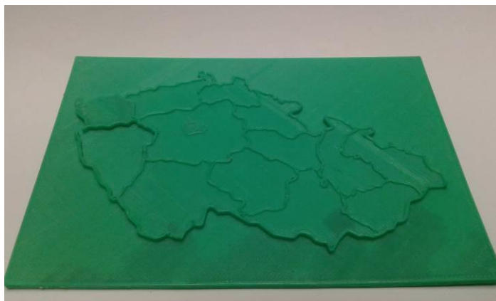
Obr. 5.2 Pokusný výtisk č.1 z ABS plastu o rozměrech 14 × 9 × 0,4 cm
