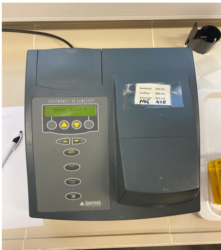
Obrázek č.20 – Spektrofotometr využívaný pro stanovení množství hemoglobinu (Hb) při nastavené vlnové délce 540 nm ( vlastní zdroj ).
