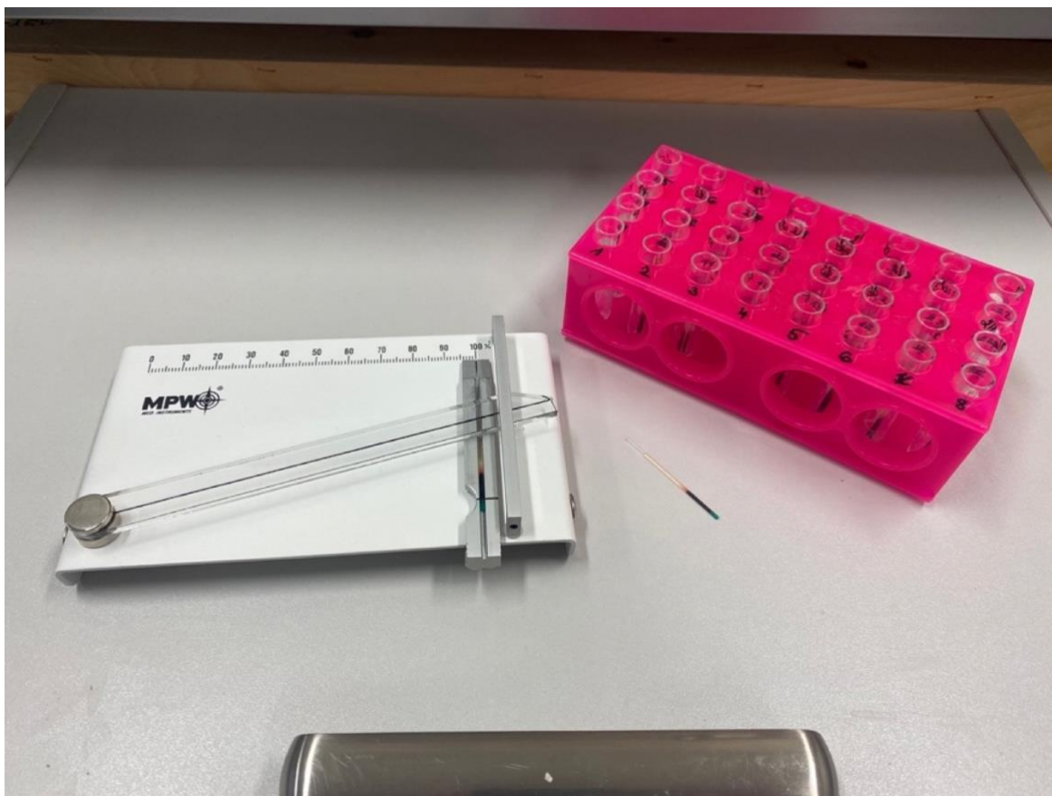
Obrázek č.19 – Finální stanovení PCV pomocí posuvného měřítka s noniem ( vlastní zdroj ).
