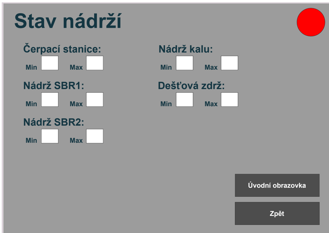
Obr. 4.16: HMI – stav nádrží.
