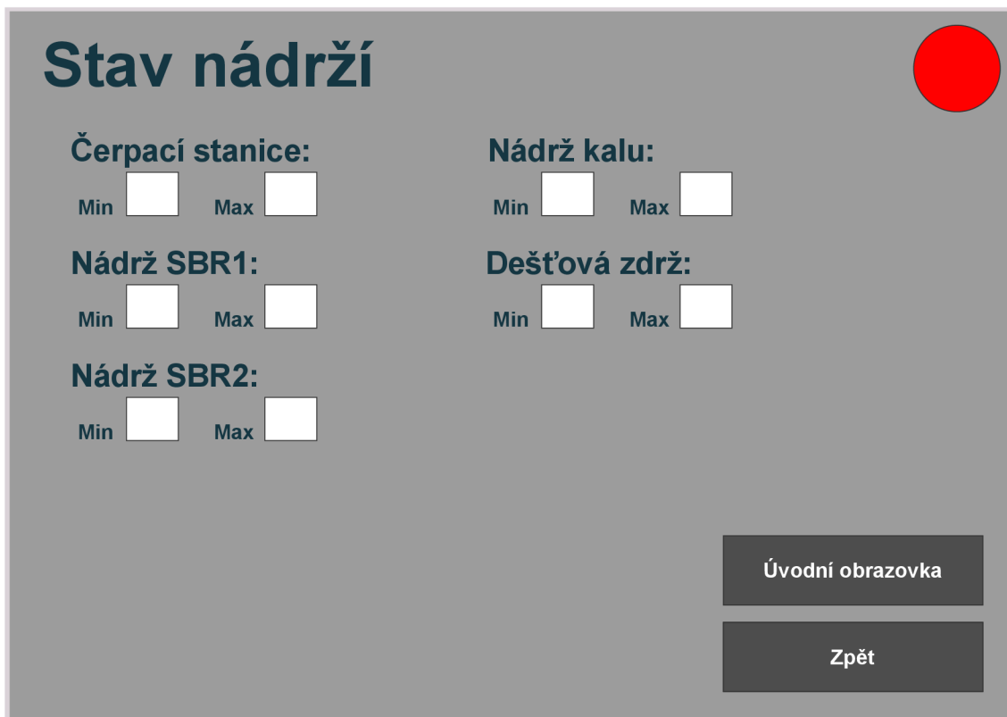
Obr. 4.16: HMI – stav nádrží.
