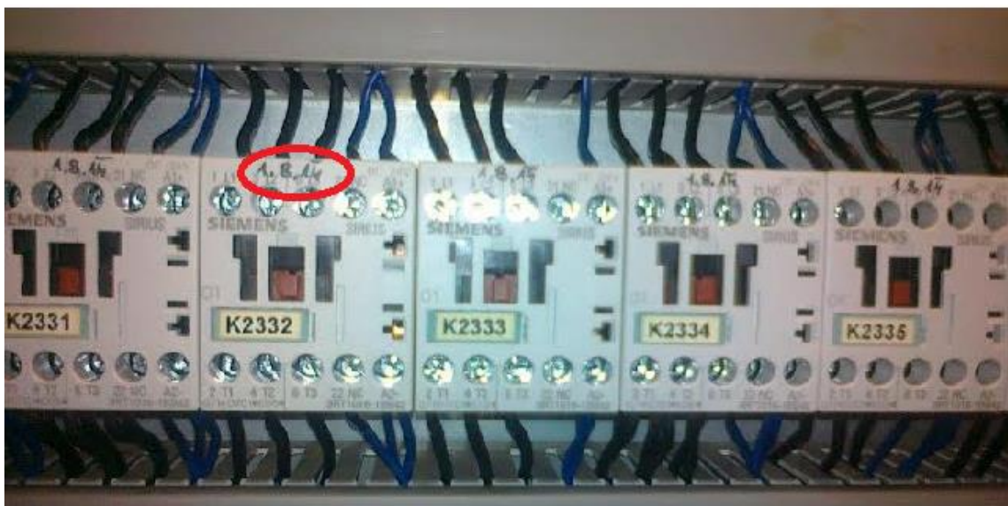
Obrázek 11 Příklad značení stykačů stroje Ghyselinc
