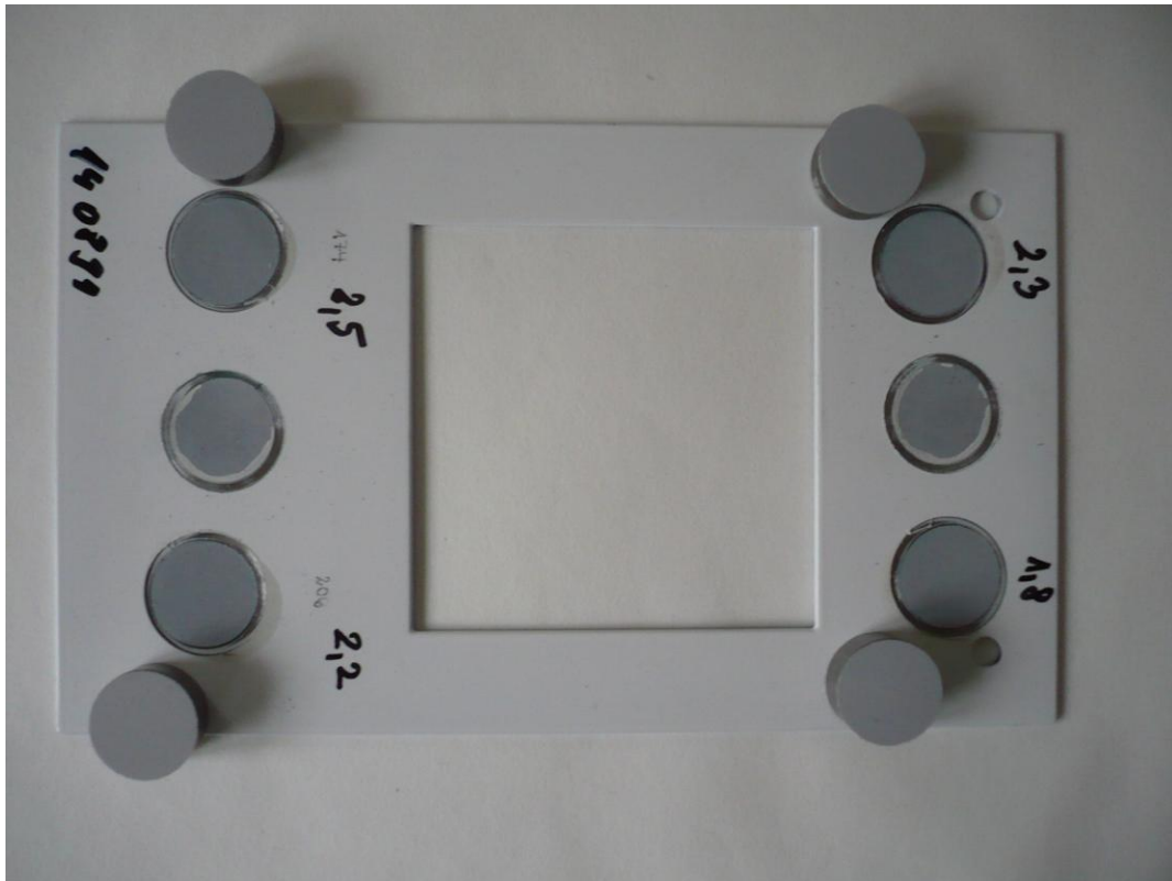
Obr. 25 Vzorek P3 po odtrhové zkoušce
