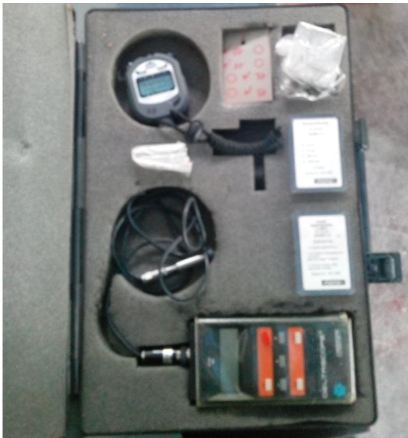
Obr. 12 Zařízení pro měření tloušťky vrstvy
