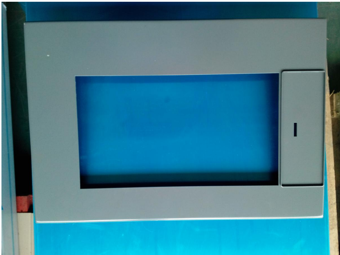
Obr. 2 Maska se základním nátěrem
