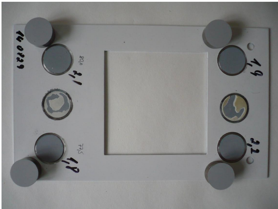
Obr. 24 Vzorek L3 po odtrhové zkoušce
