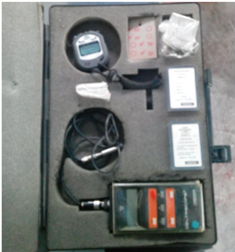
Obr. 12 Zařízení pro měření tloušťky vrstvy
