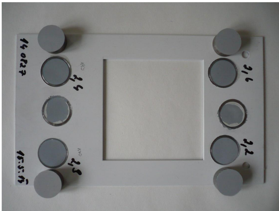
Obr. 23 Vzorek B3 po odtrhové zkoušce
