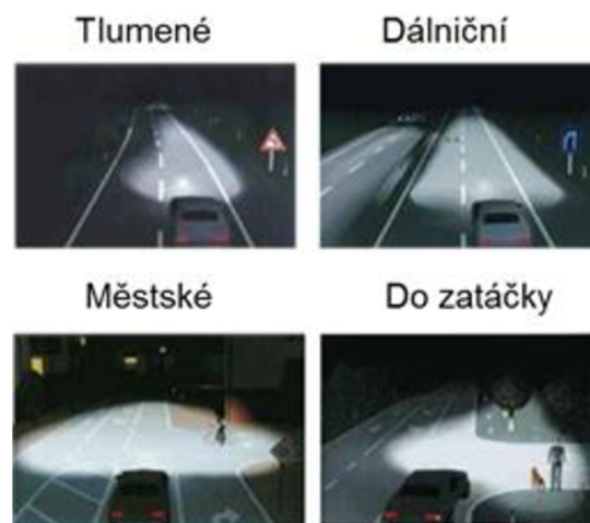
Obr. 1.7 Funkce adaptivních světlometů [4].
