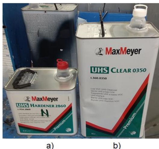
Obr. 5.22 Použité látky pro tvorbu směsi na lakování: a) lak MayMeyer UHS Clear 0350 b) tužidlo MayMeyer UHS Hardener 2860.
