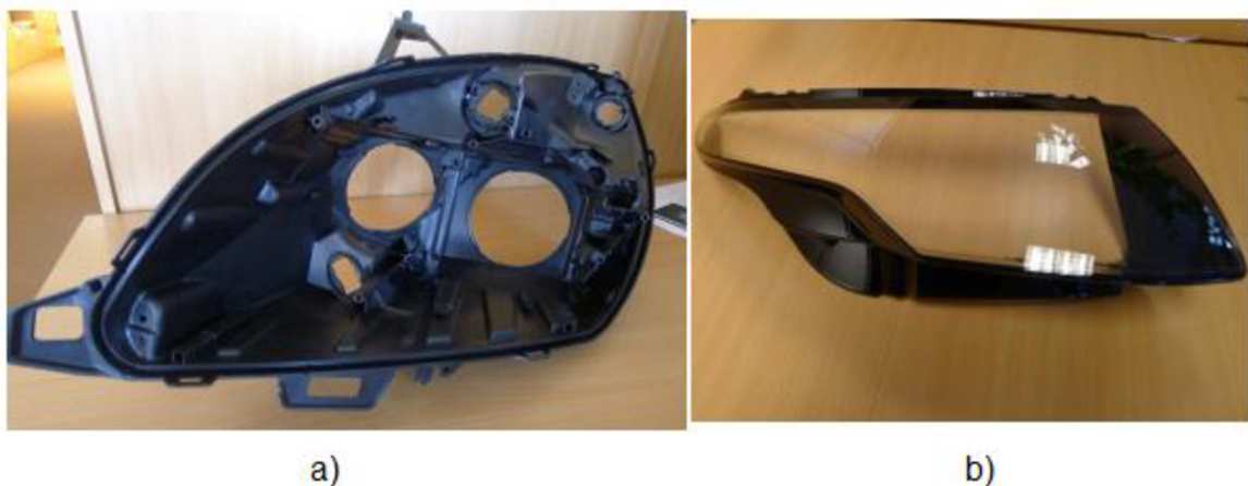
Obr. 1.3 Vnější části světlo metu [7]: a) pouzdro b) krycí sklo.
