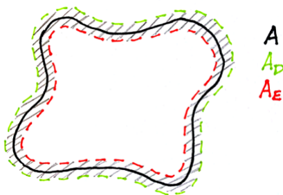
Obrázek 3.9: Detekce hran dilatací a erozí
