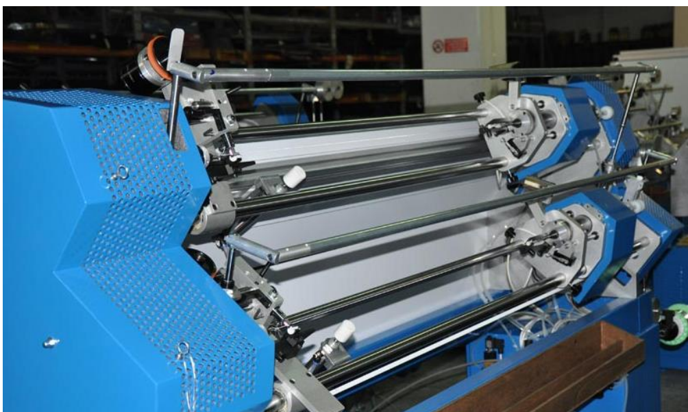
Obr. 6.5 Současný oplétací stroj [12].
