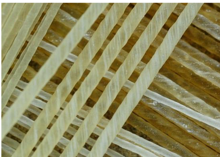
Obr. 2.2 Struny vyrobeny ze střev [13].
