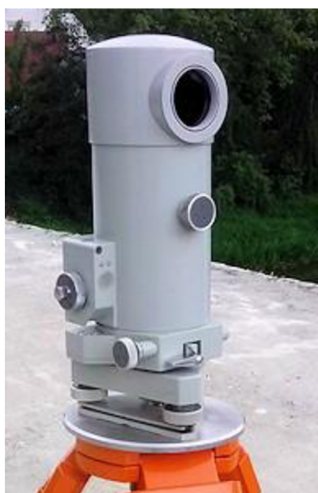
Obr. 4.2: Nivelační přístroj Zeiss Koni 007 [19]
