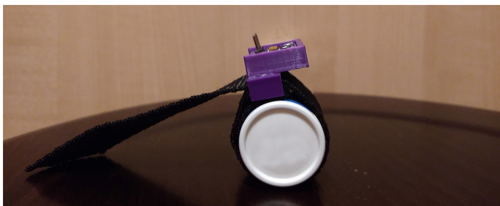
Obr. 5.2: Finální verze úchytu senzoru na volant
