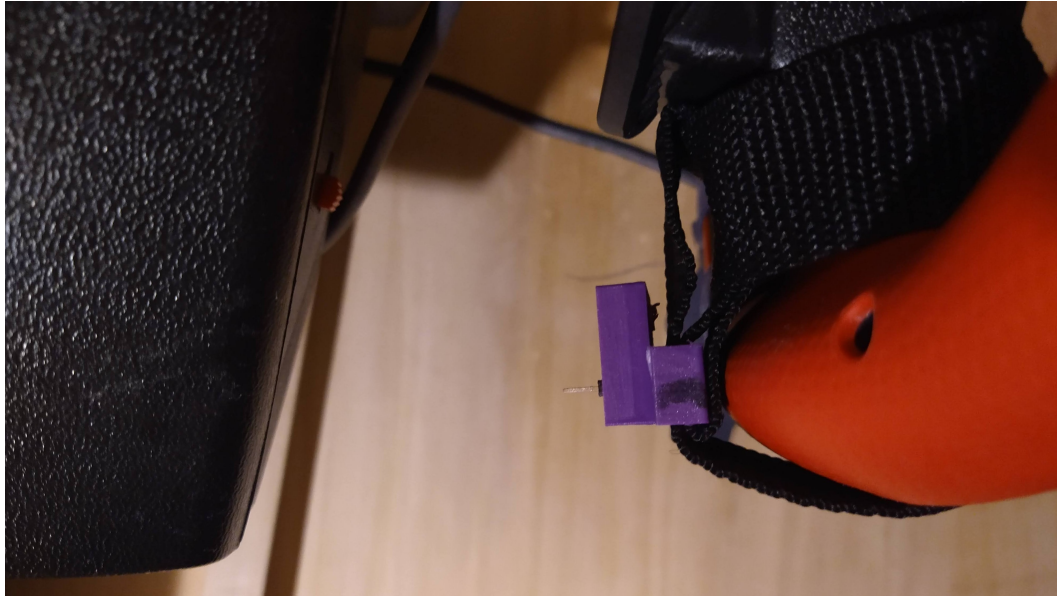
Obr. 5.3: Modifikace úchytu pro uchycení v místě paprsku volantu
