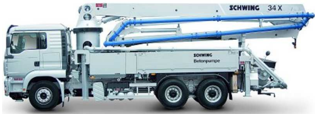
Obr. 5.2.11 Autočerpadlo Schwing S 34 X (převzato z [4] )
