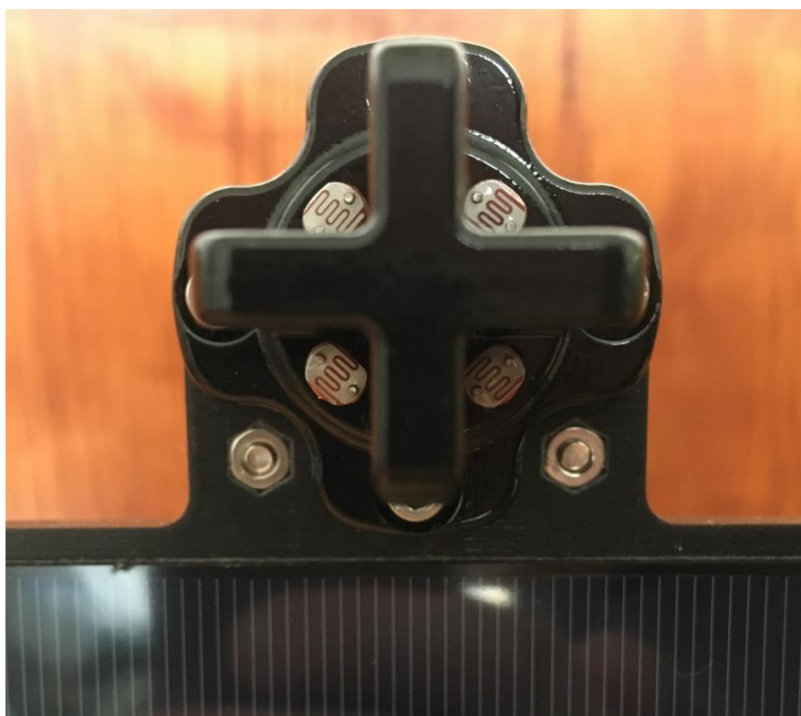
Obrázek 45: Připojení senzoru kolmosti zdroje světla.
