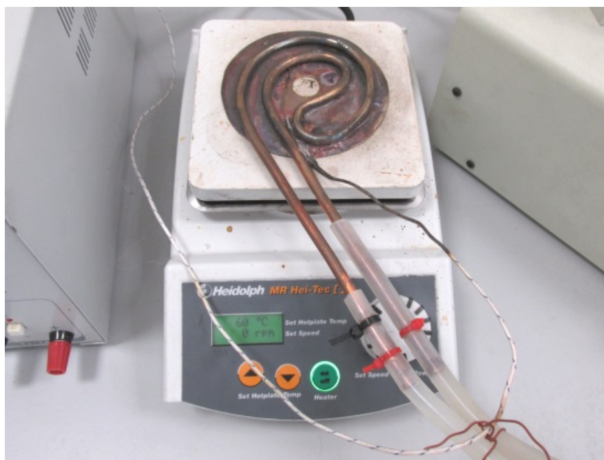
Obr. 2.20: Chladicí blok za provozu
