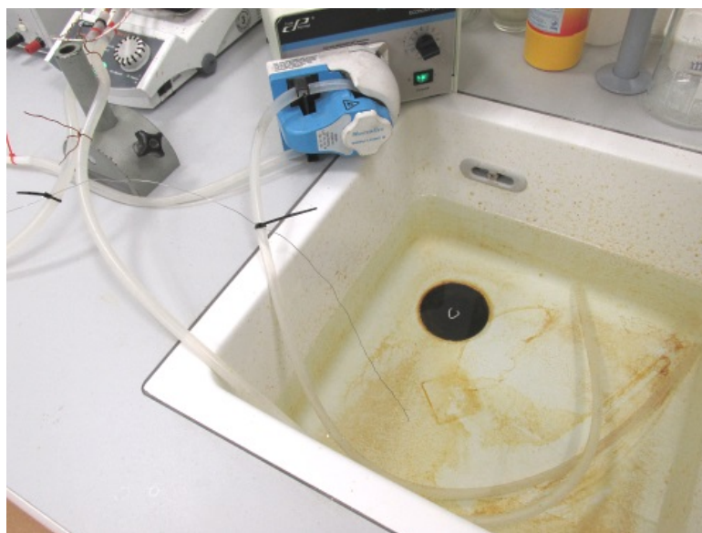
Obr. 2.21: Čerpání vody z nádrže
