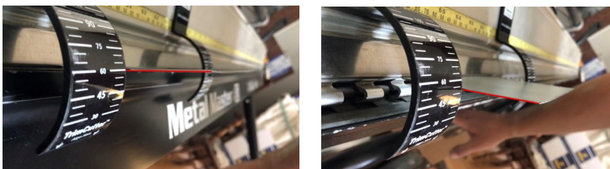
Obr. 24) Poloha plechu před uvolněním ohýbací čelisti a po uvolnění čelisti (velikost ohybu 60°).
