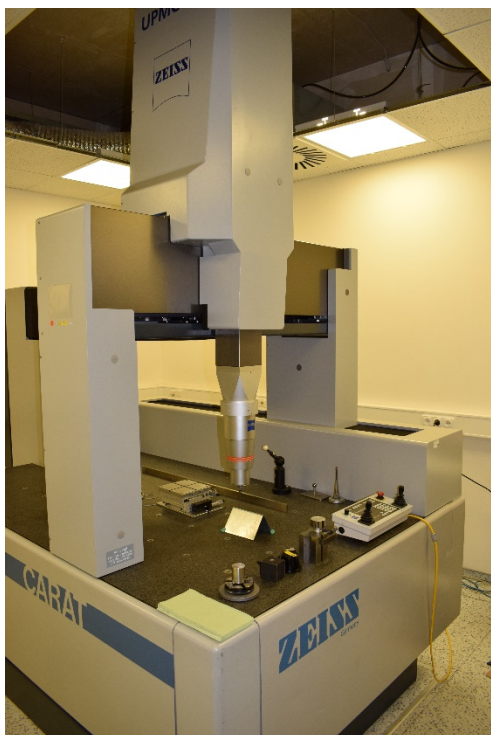
Obr. 27) Zařízení Zeiss UPMC 850 Carat (vlevo). Dotyk senzoru s měřenou rovinou vzorku (vpravo).
