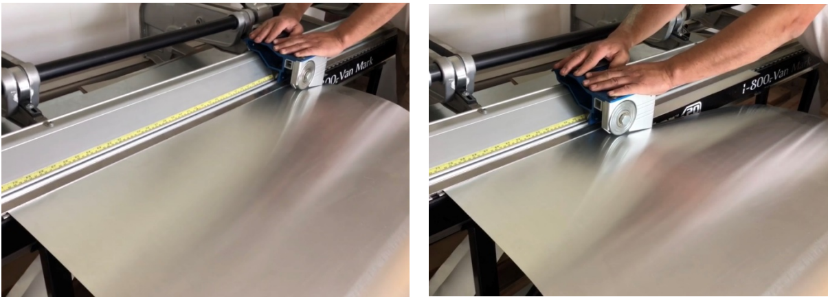
Obr. 18) Řezání plechových tabulí pomocí příslušenství Trim Cutter.
