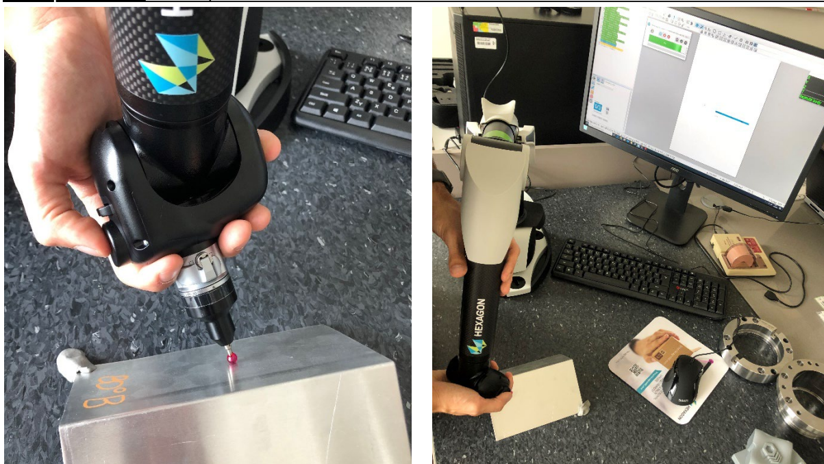
Obr. 31) Měření dotykovým měřícím zařízením Hexagon Absolute Arm 8312-6.
