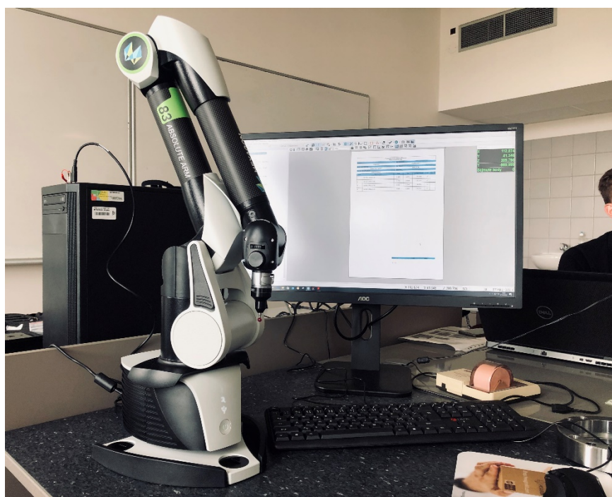
Obr. 32) Pracoviště vybavené ramenem Hexagon na FSI 23 .
