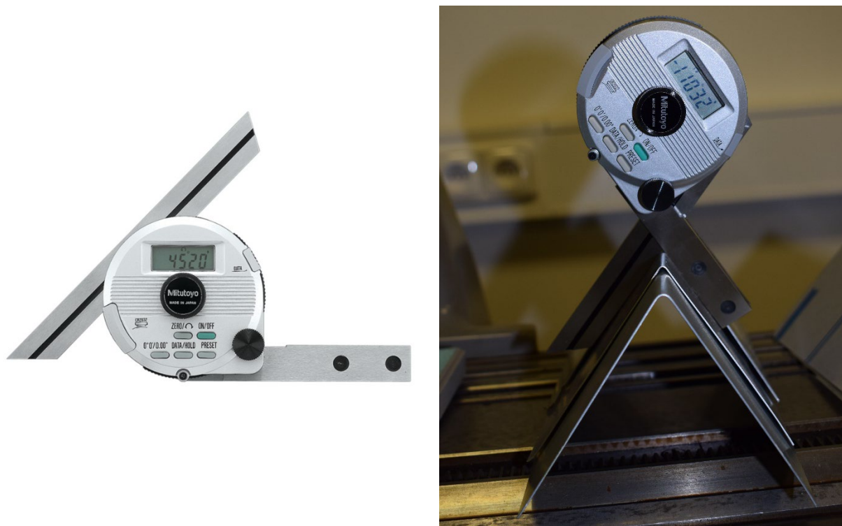
Obr. 33) Digitální úhloměr MITUTOYO (vlevo). Měření parametrů ohybu u zkoumaných vzorků (vpravo). [17]
