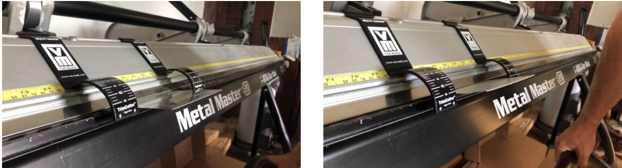
Obr. 20) Průběh ohybu vzorku na hodnotu 30°. Vlevo je znázorněna počáteční pozice plechu a rukojeti. Vpravo je zobrazena závislost polohy ohýbací čelisti vůči velikosti úhlu ohybu.
