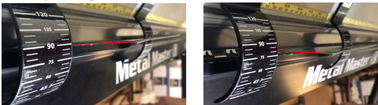
Obr. 25) Poloha plechu před uvolněním ohýbací čelisti a po uvolnění čelisti (velikost ohybu 90°).
