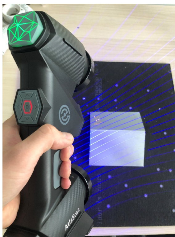
Obr. 41) Skenování plechu optickým zařízením.
