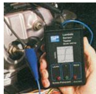
Obr. 28 Přístroj na zkoušení funkce lambda sondy SP 300730 [33]
