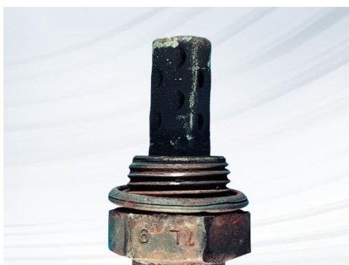
Obr. 22 Karbonové usazeniny na lambda sondě [25]
