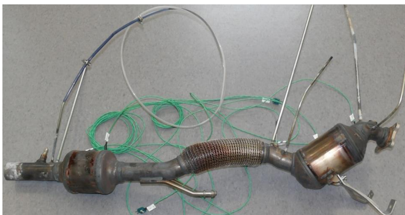
Obr. 44 Měřená výfuková soustava osazená teplotními senzory a emisními výstupy – detail
