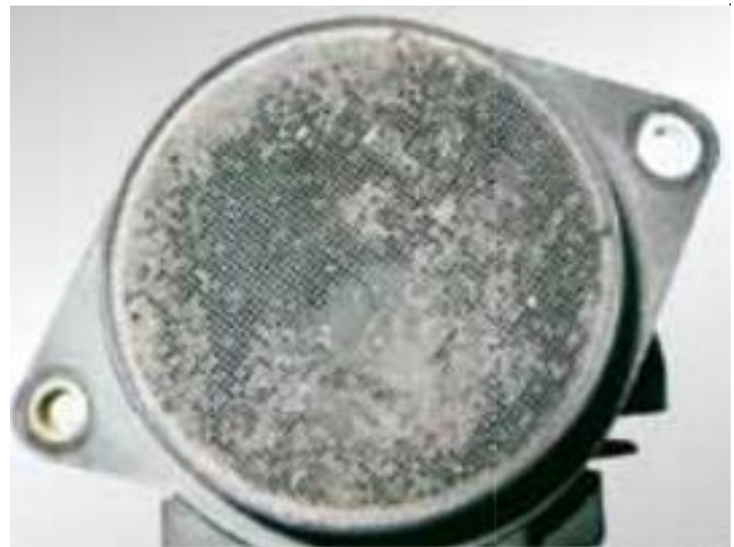
Obr. 27 Ucpaný snímač hmotnosti vzduchu [22]
