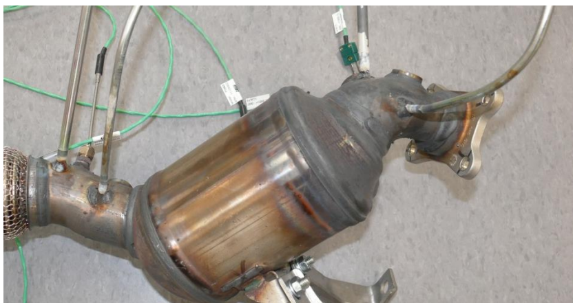
Obr. 44 Měřená výfuková soustava osazená teplotními senzory a emisními výstupy – detail
