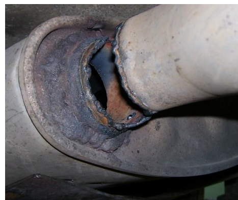
Obr. 19 Zkorodovaný a rozpojený výfuk [26]
