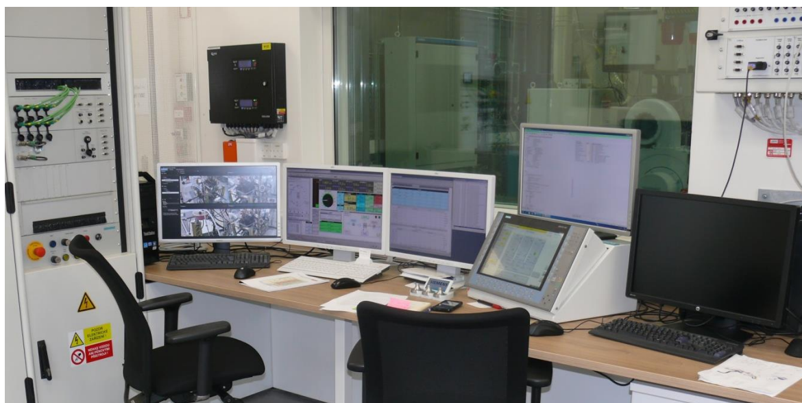
Obr. 36 Řídicí stanoviště brzdové zkušebny
