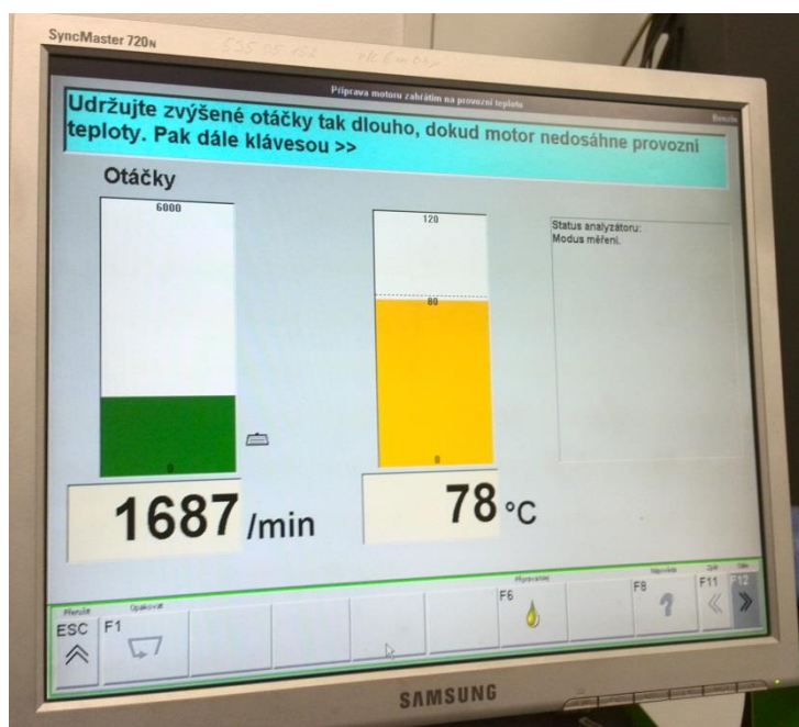
Obr. 31 Kontrola dosažení požadované teploty oleje při měření emisí
