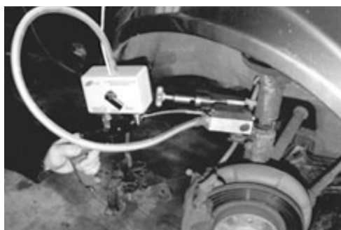
Obr.18a- Odsávní tlumičového oleje
