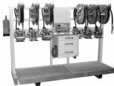
Obr. 17a- Stojan samonabíjecích hadic zakončených rychlospojkami
