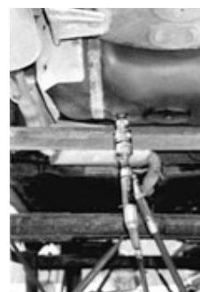
Obr.18b- Odsátí paliva z autovraku
