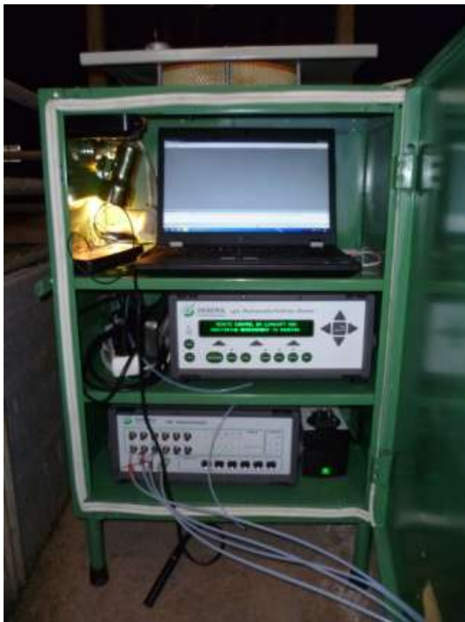
Obrázek č.6 Přístroj INNOVA 1412 zapojená při měření
