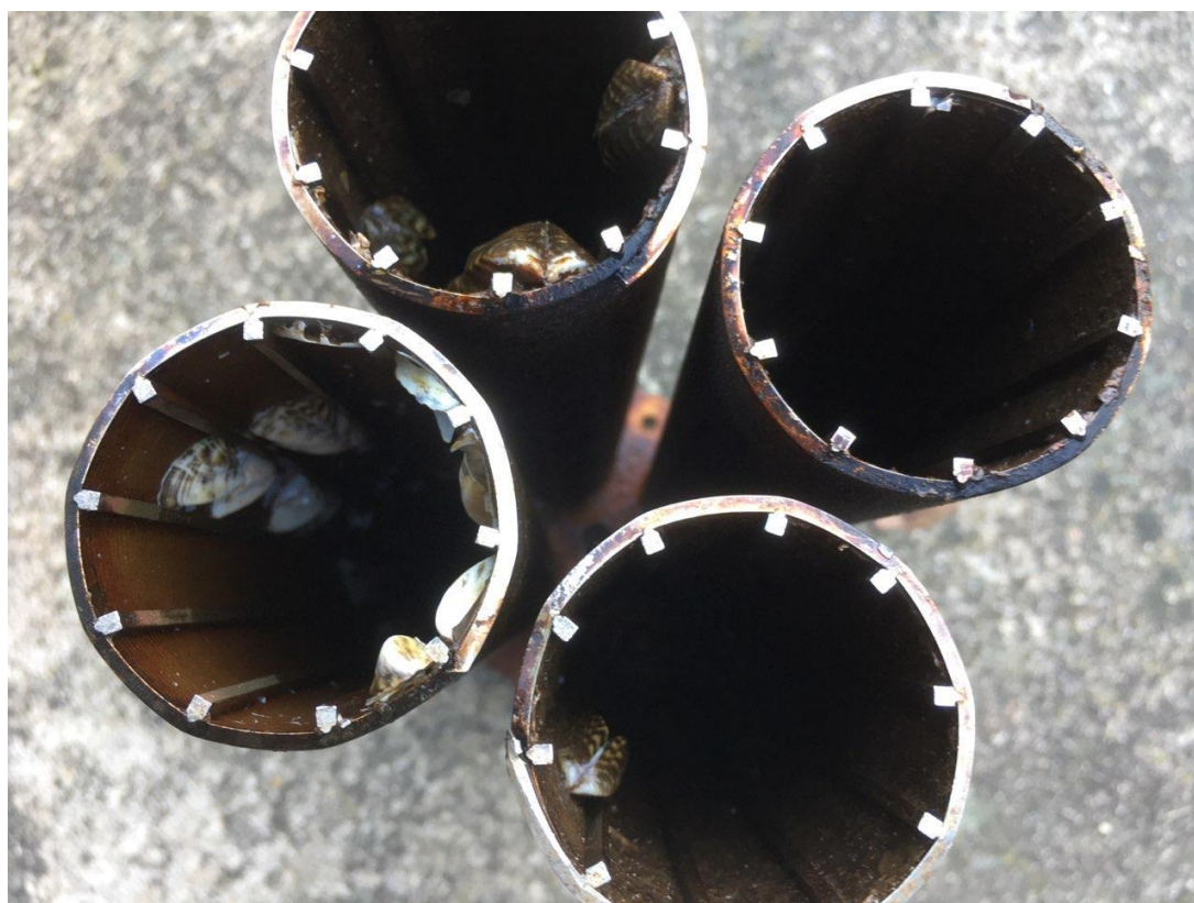
Obrázek 14 Nálezy slávičky na VE Mohelno – zanesené filtry Hydac (Čtyrská ©2019)
