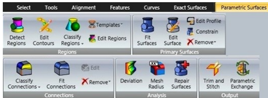
Obrázek 27 Uživatelský panel v parametrickém režimu v programu Geomagic Studio
