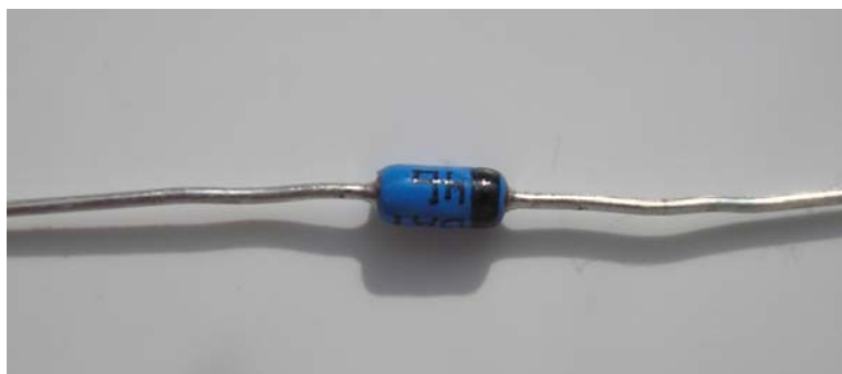
Obrázek 11.3: Schottkyho dioda BAT46
