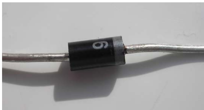
Obrázek 11.5: Univerzální dioda 1N4936
