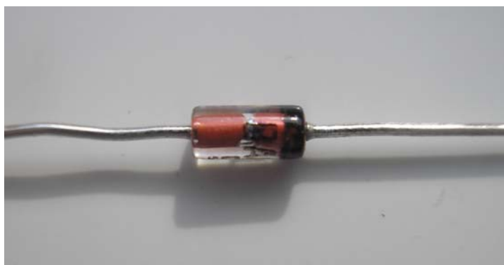
Obrázek 11.4: Univerzální dioda BAV21
