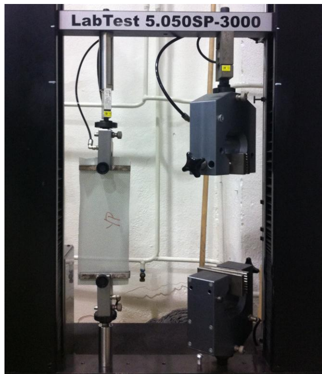
Obrázek 18: Trhací zařízení na testování textilie
