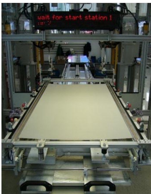
Obrázek 11: Založení rámu s textilií do přípravku
