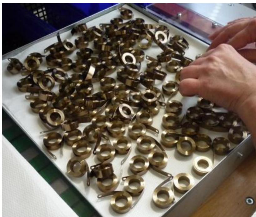
Obrázek 10: Pružiny po vyjmutí z odmašťovací lázně
