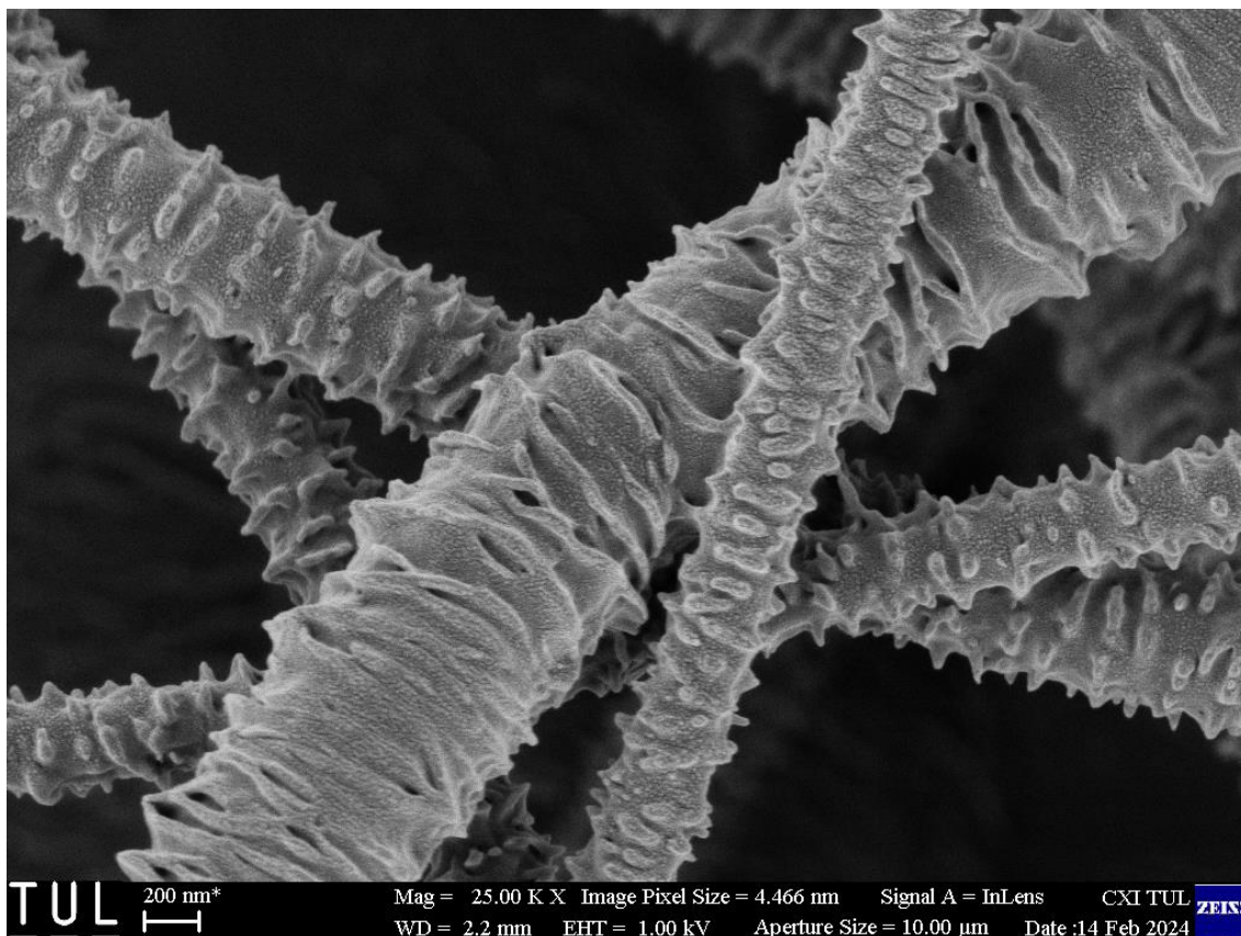
Obrázek 30: Shish-kebab struktura na materiálu PCL80_82_PA45. SEM Zeiss, měřítko 200 nm.
