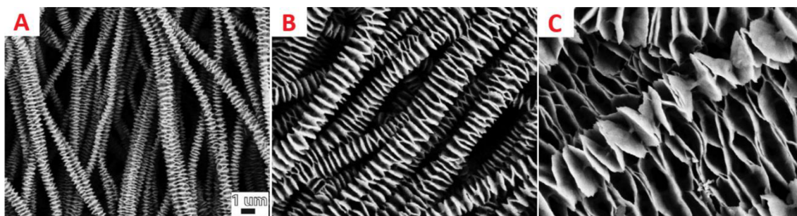
Obrázek 16: PCL NFSK připravená inkubační metodou (15 minut) s koncentrací krystalizačního roztoku A) 0,5; B) 1 a C) 3 % w/v kopolymeru PCL-PAA ve směsi pentyl-acetátu a ethanolu o poměru 1:1. [52]
