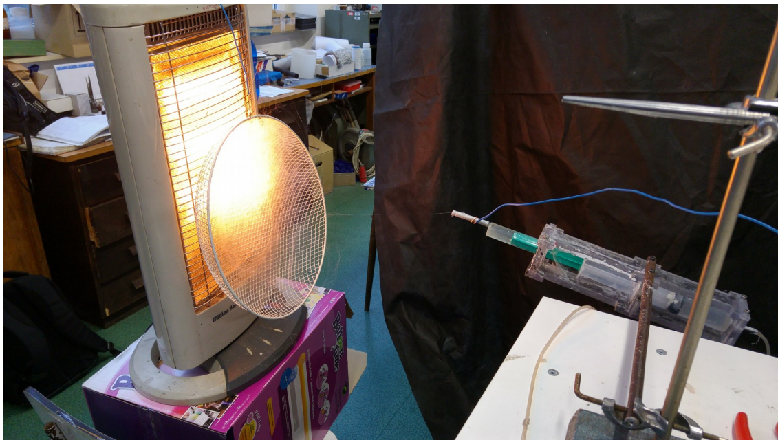
Obrázek 15: Modifikovaná aparatura pro AC elektrospinning roztoků citronanů v PVA
