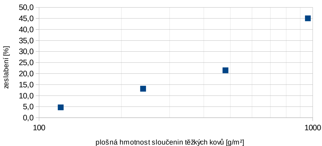
Diagram 9: Zeslabení gamma záření vrstvou PVB nanovláken s 75 % obsahem anorganických částic
