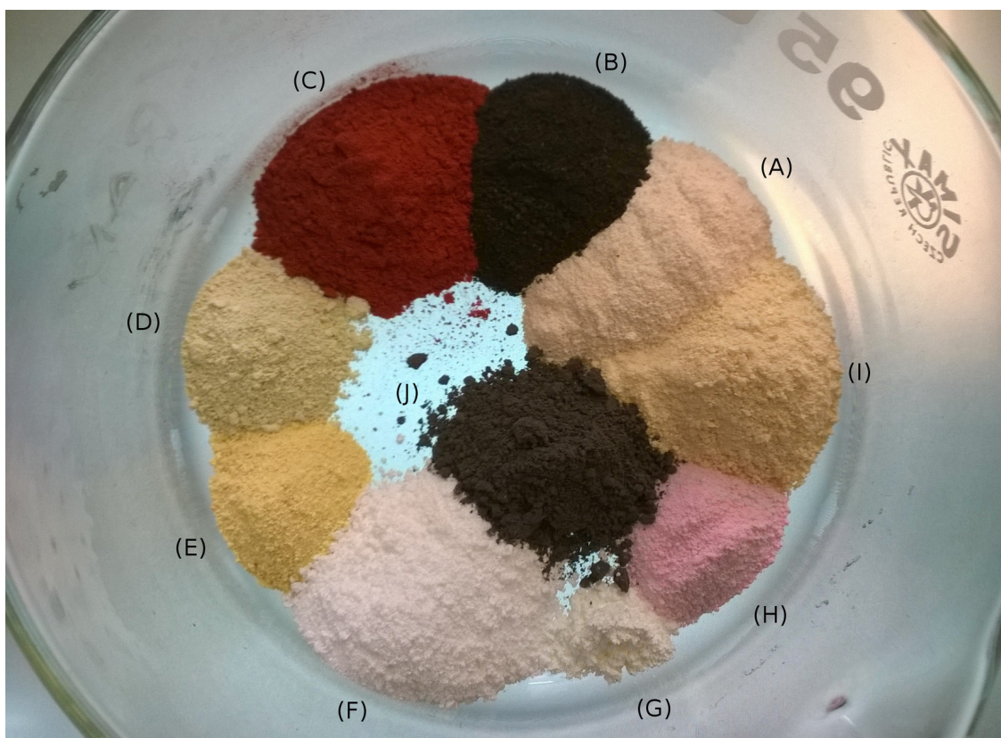
Obrázek 23: Směs práškových materiálů ( A=Ho_2O_3 , B=Pr_6O_{11} , C=BiI_3 , D=Pr_2(WO_4)_3 , E=Bi_2O_3 , F=Lu_2O_3 , G=Tm_2O_3 , H=Er_2O_3 , I=Gd_2O_3 , J=(Gd/Pr)_2O_3 )
