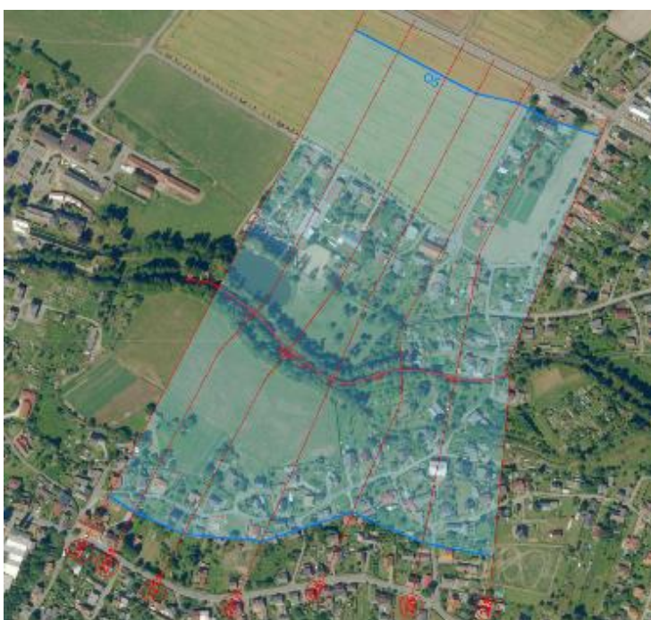
Obrázek 39: Grafické znázornění rozlivu při průtoku Q_5 – „stávající stav“ v ř. km 14,247 – 14,674 (Jílková 2020).
