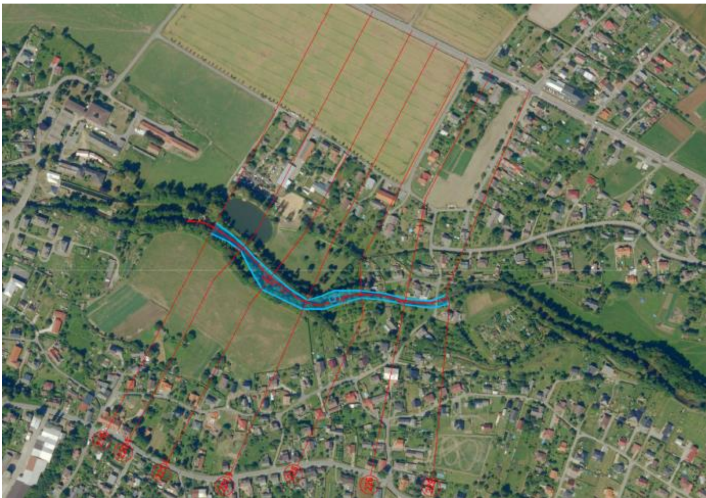
Příloha 3: Grafické znázornění rozlivů pro průtok Q_1 před navrženou úpravou PPO v řešeném úseku ř. km 14,247 – 14,674 (Jílková 2020).
