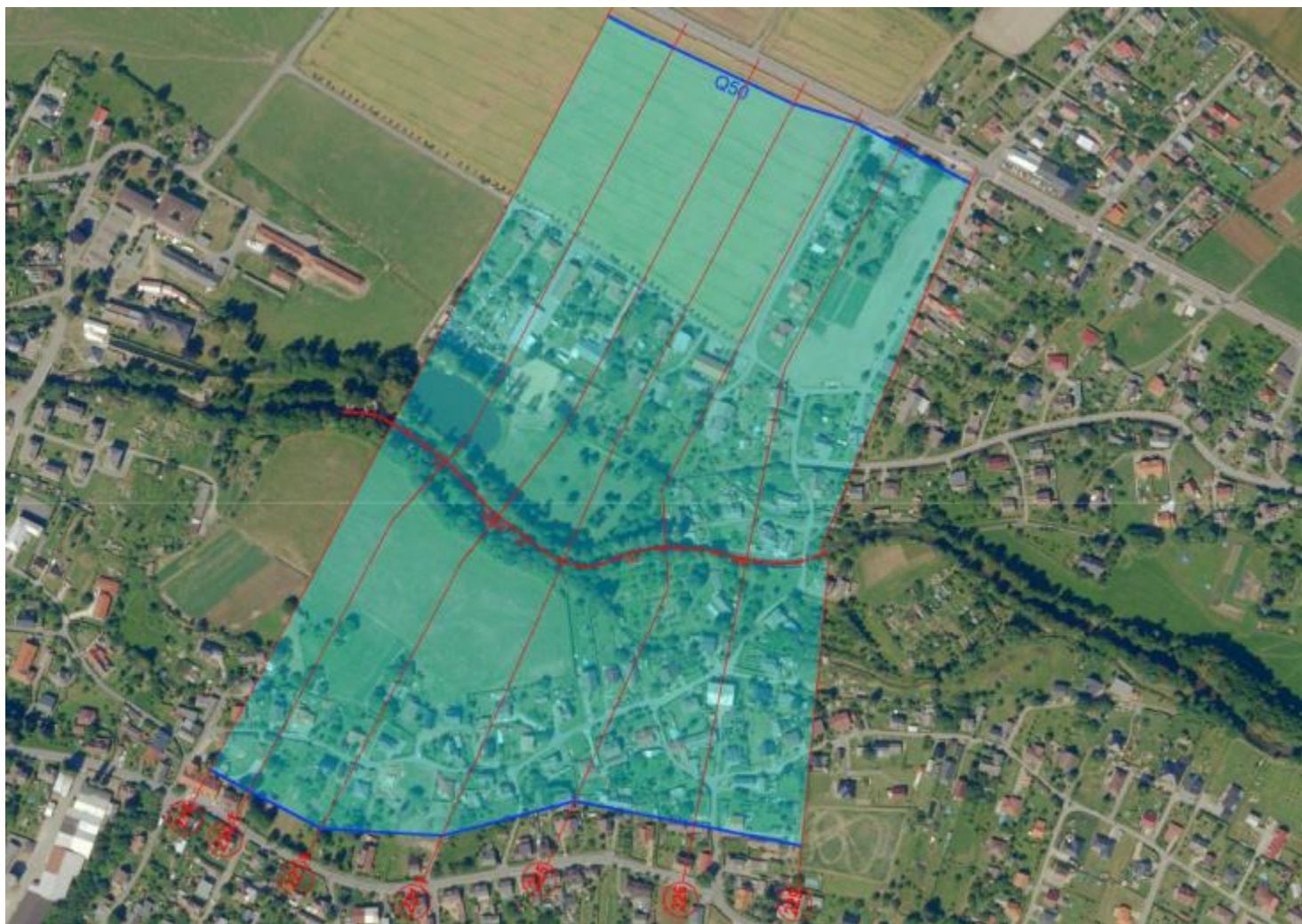
Příloha 5: Grafické znázornění rozlivů pro průtok Q_{50} před navrženou úpravou PPO v řešeném úseku ř. km 14,247 – 14,674 (Jílková 2020).
