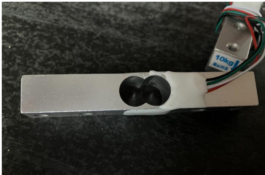
Obrázek 20 Tenzometrické taktilní senzory (Autor práce)
