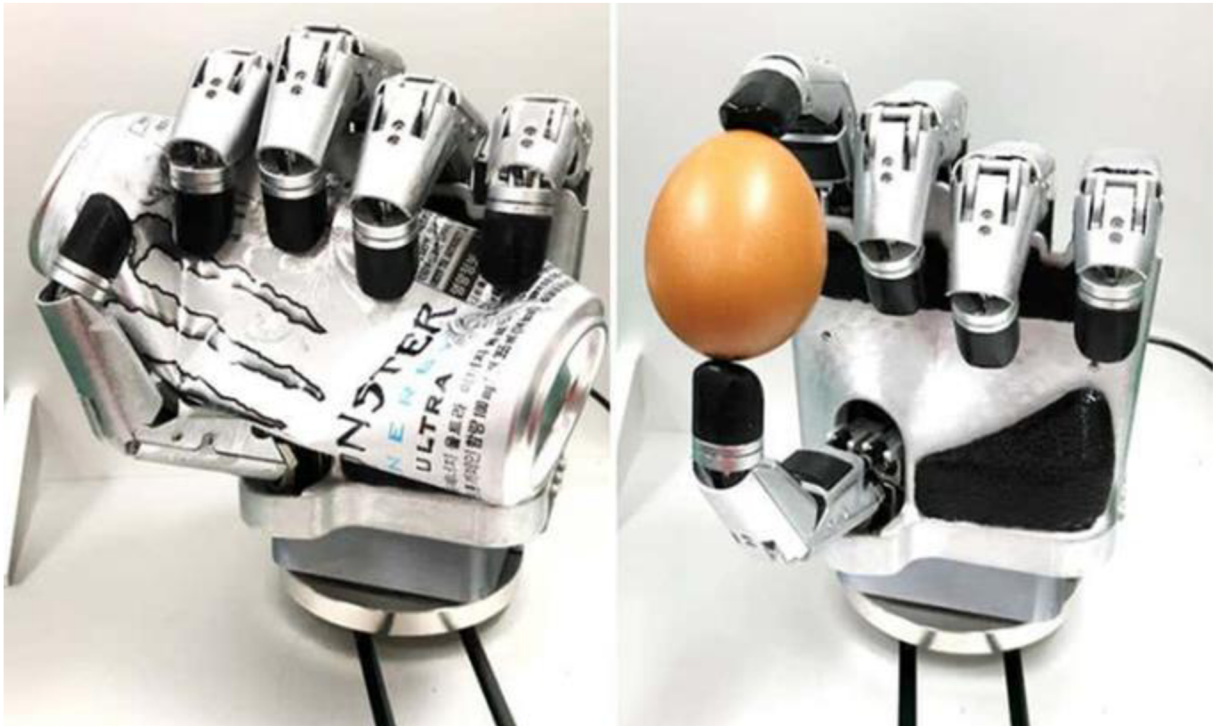
Obrázek 8 Robotická ruka s taktilními senzory (15)
