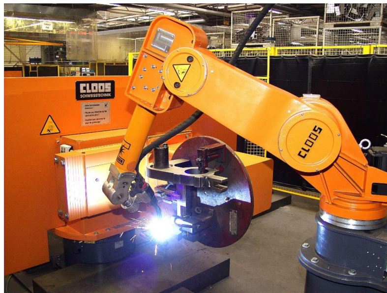
Obrázek 7 Robot se svařovacím efektem (14)
