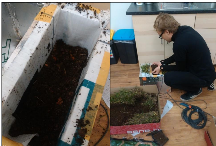
Obr. 40 Nasypání nezpevněné spodní vrstvy zeminy (archiv autora, 2016)
