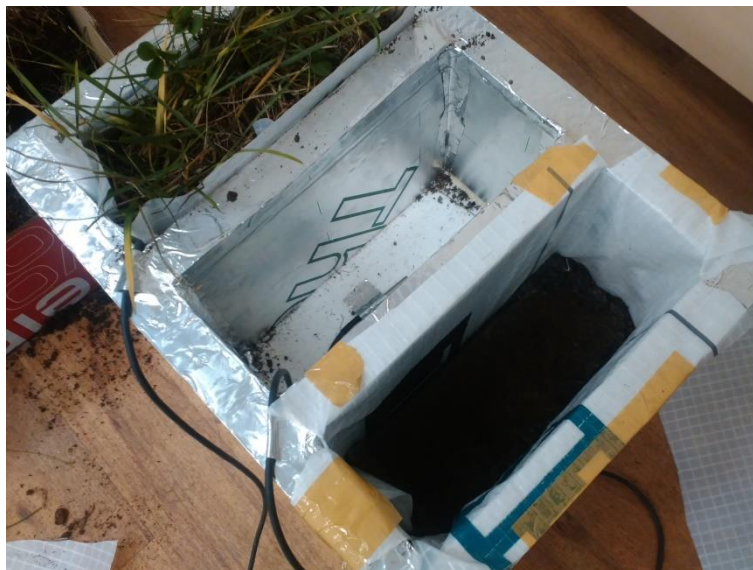
Obr. 39 Zkušební vzorek, levý element hotový, v pravém přilepena parotěsná fólie a vložen RETEX (archiv autora, 2016)
