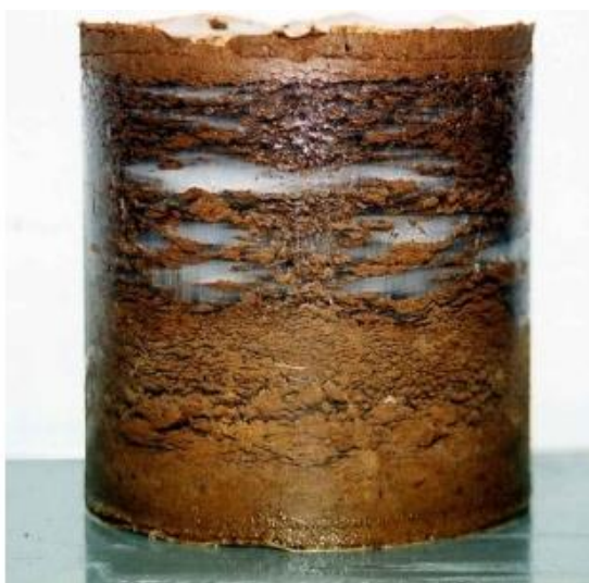
Obr. 54 Ledové čočky ve zkušebním vzorku [22]
