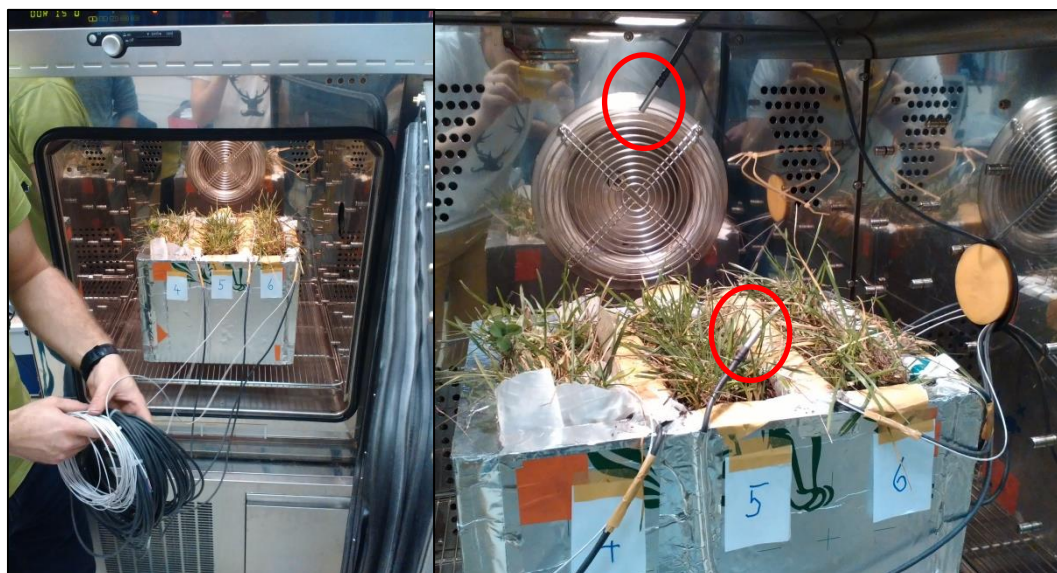
Obr. 44 Zkušební box B v klimakomoře po připojení teplotních čidel a utěsnění jejich prostupu (archiv autora, 2016)
