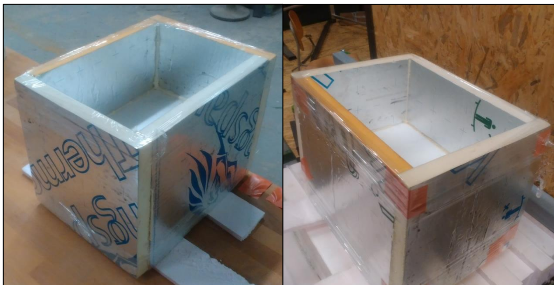
Obr. 36 Vzorčky spojeny pomocí lepidla a zafixovány pomocí streč-fólie (archiv autora, 2016)
