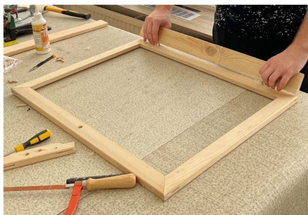
Obrázek 22 Výroba rámu zrcadla
