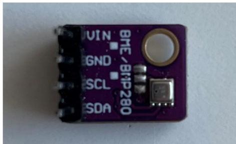
Obrázek 7 BME-280 – Senzor teploty, vlhkosti a barometrického tlaku
