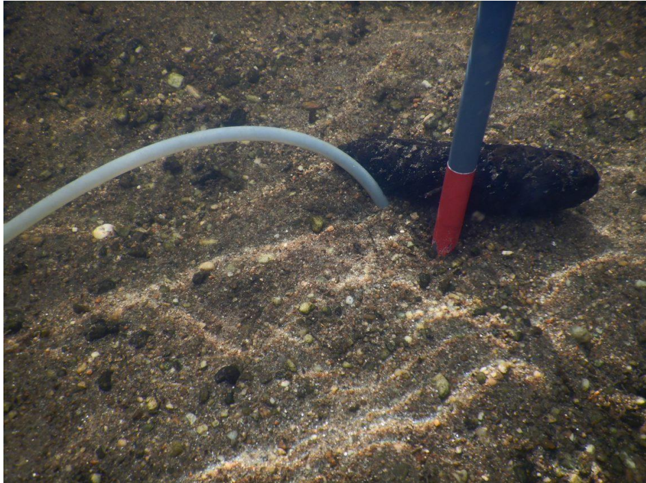
Příloha 3: Příklad flexibilní hadičky umístěné v bioindikační destičce a měření redox potenciálu ve dně toku – Teplá Vltava, zdroj: Simon.
