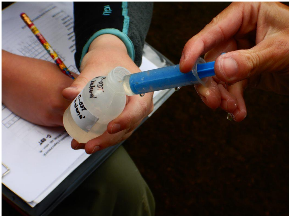
Příloha 6: Přelévání odebraného vzorku hyporeálové vody ze stříkačky do vzorkovnice a zápis naměřených hodnot, zdroj: Simon.
