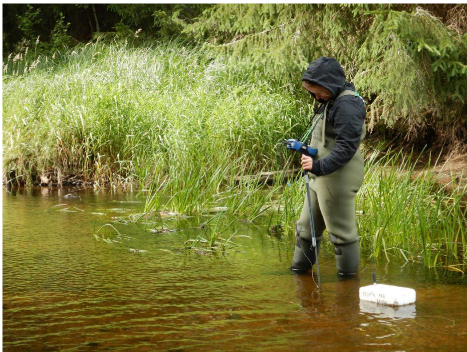
Příloha 2: Měření redoxního potenciálu – Teplá Vltava, zdroj: Simon.
