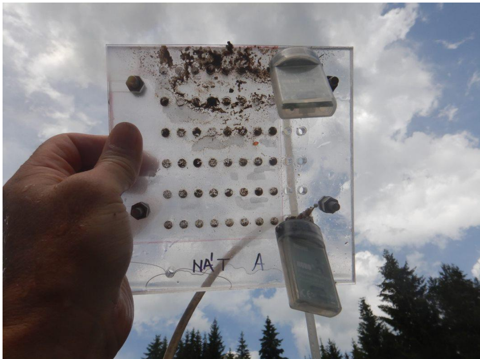
Příloha 4: Bioindikační destička vyjmuta z říčního hyporeálu v lokalitě Nátok – Teplá Vltava, zdroj: Simon.
