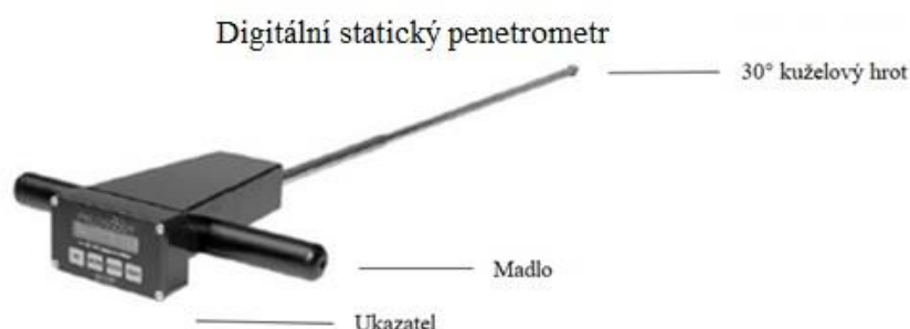
Obr. 5: Digitální statický penetrometr-model Field Scout TM SC 900, upraveno podle (Moraes et al., 2014).
