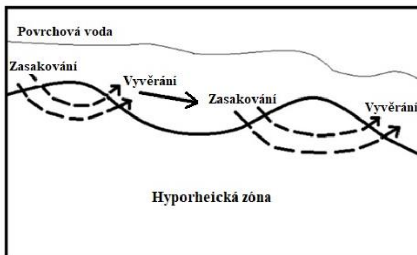
Obr. 1: Hyporheická zóna – znázorněna místa zasakování a vyvěráni vody na povrch, upraveno dle (Boulton, 2007).
