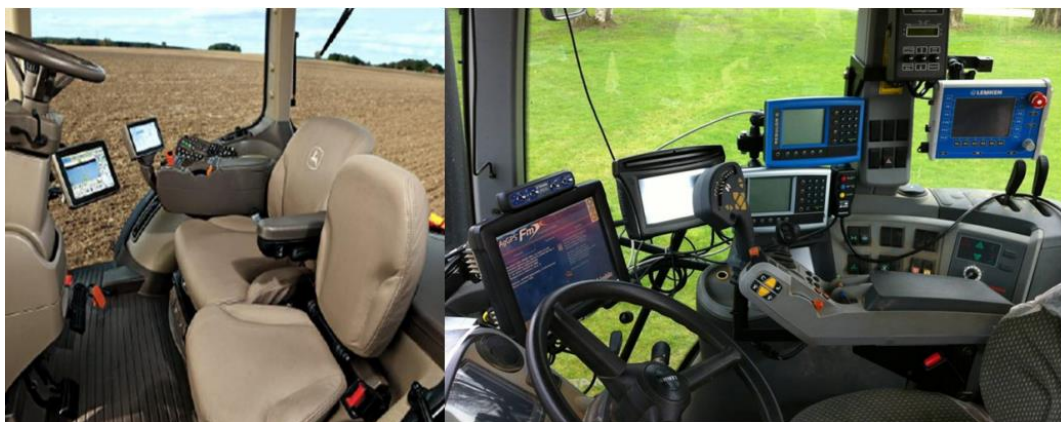
Obr. 1. Vlevo traktor vybavený sběrní ISOBUS, vpravo bez ISOBUS výbavy. (John Deere, 2014)
