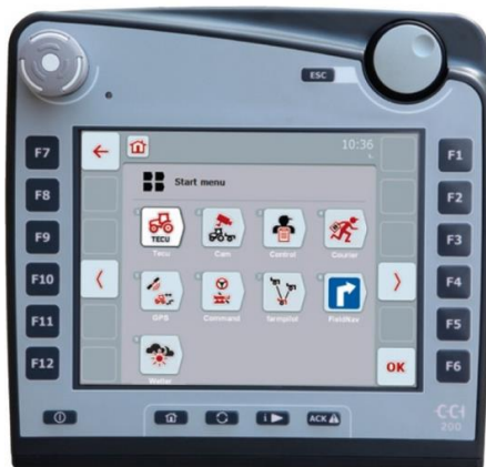
Obr. 43. Terminál CCI 200. (CCI ISOBUS, 2014)
