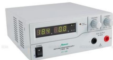
Obr. 48. Laboratorní zdroj Manson HCS-3200-000G. (GME, 2014)
