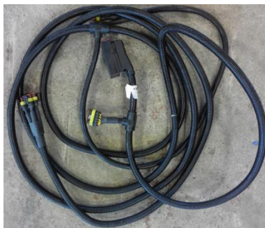
Obr. 31. Připojovací svazek jednotky č. 2
