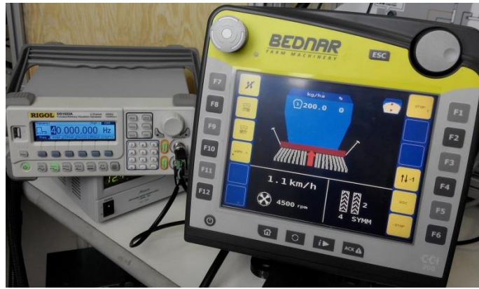
Obr. 36. Generátor RIGOL LG 1022A – generuje signál o frekvenci 40 Hz tedy o hodnotě 1.1 \text{ km} \cdot \text{h}^{-1}
