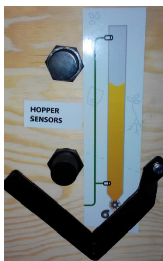
Obr. 26. Snímače hladiny osiva s grafikou na dokončené tabuli.
