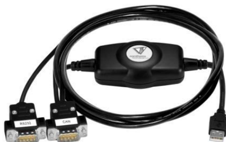
Obr. 59. Analyzátor sběrnice CANFOX od firmy Sontheim. (Sontheim, 2014)
