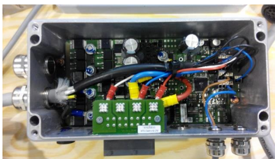
Obr. 24. Otevřený Motor modul secího stroje.
