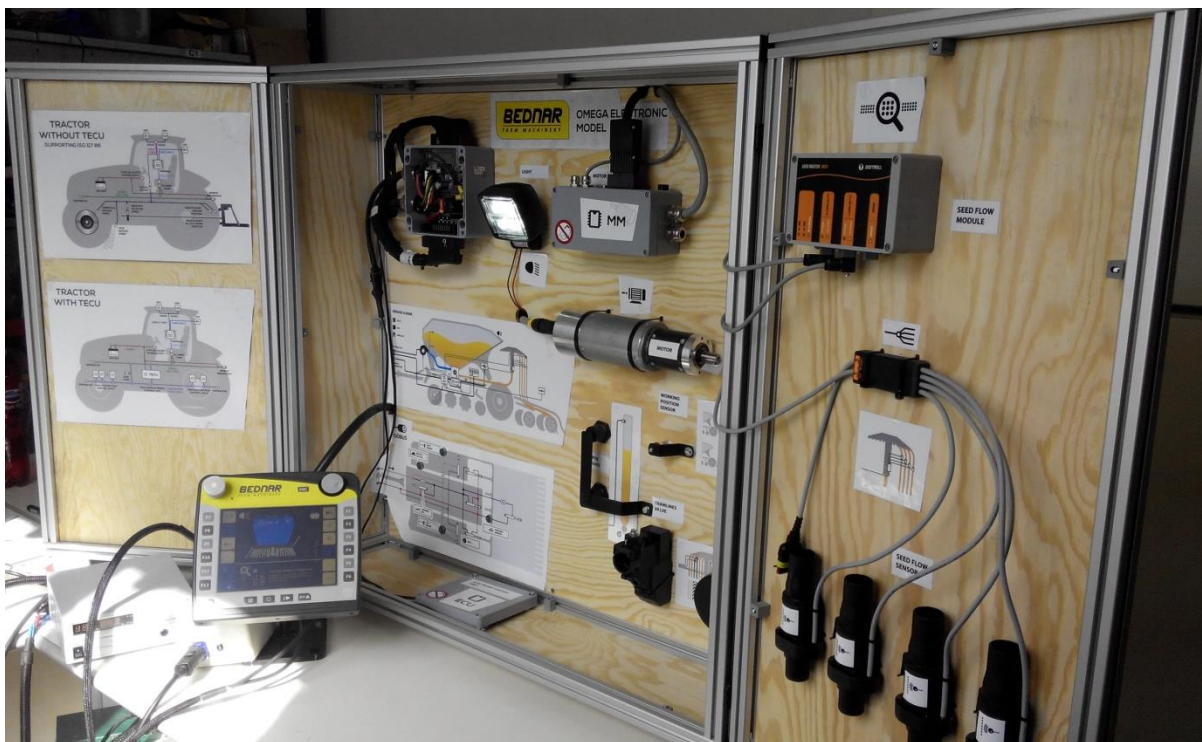
Obr. 42 Dokončená modelová školící a prezentační tabule pro Secí stroj Omega OO firmy Bednar FMT s ISOBUS sběrnici Zavřenou tabuli určenou pro transport je možné vidět v příloze 1.
