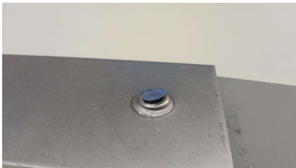
Obr. 49 Deformace dna nýtu po zkoušce
