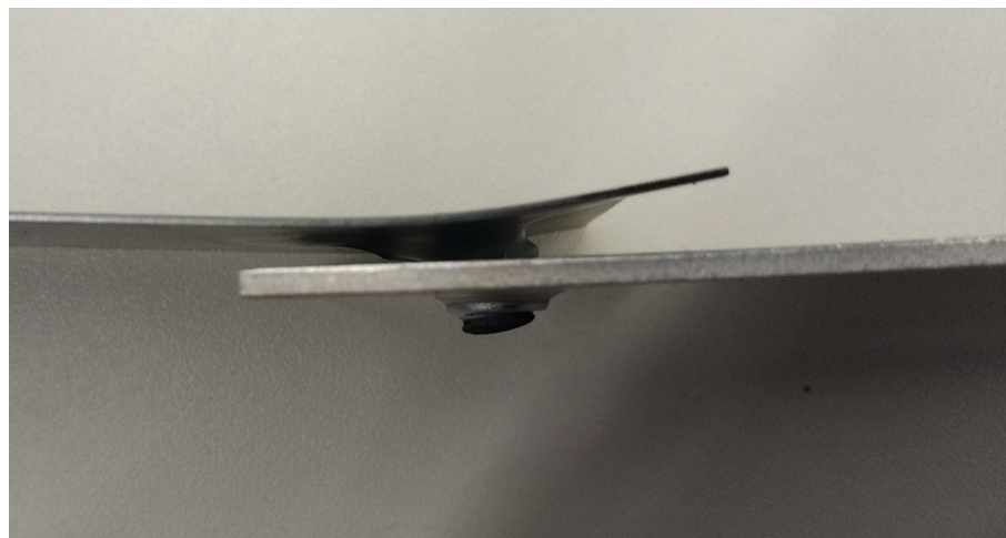
Obr. 48 Deformace vzorku po zkoušce
