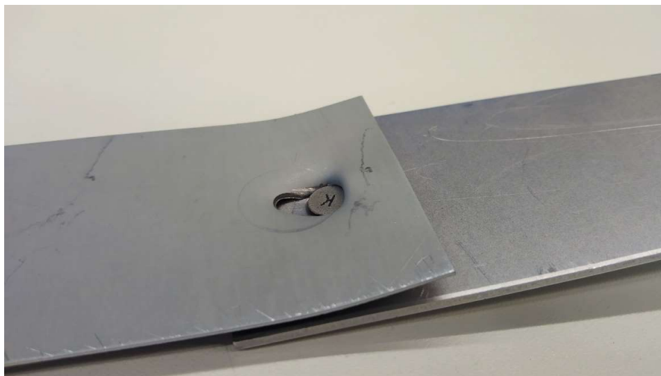
Obr. 50 Deformace plechu po zkoušce
