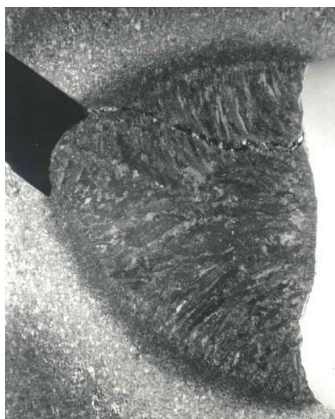
Obr. 10 Trhlina ve svaru [16]
