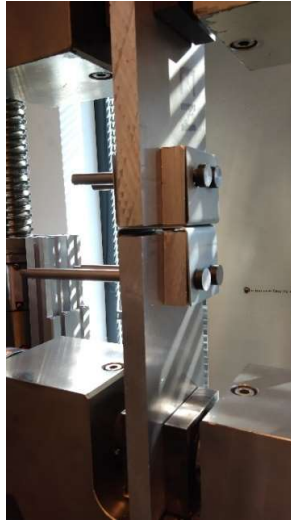
Obr. 51 Vzorek upnutý v přípravku pro zkoušku tahem
