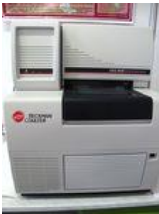
Obr. 7. Sekvenátor značky Beckman Coulter (Bártová, 2011).
