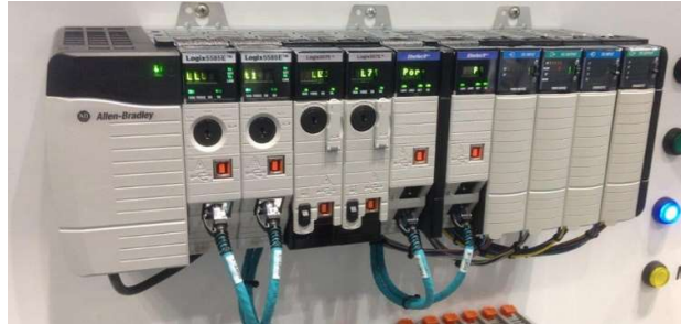
Obrázok 2 Allen Bradley ControlLogix 5580 komunikujúci cez Ethernet/IP [5]
