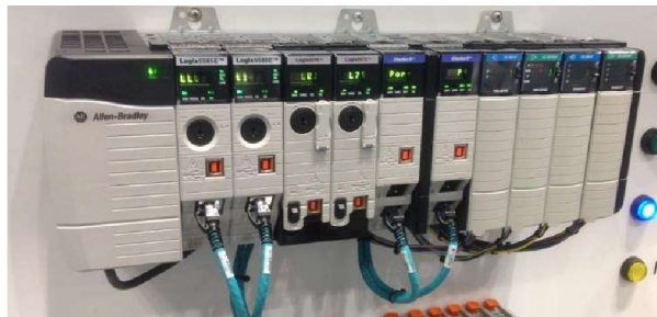
Obrázok 2 Allen Bradley ControlLogix 5580 komunikujúci cez Ethernet/IP [5]
