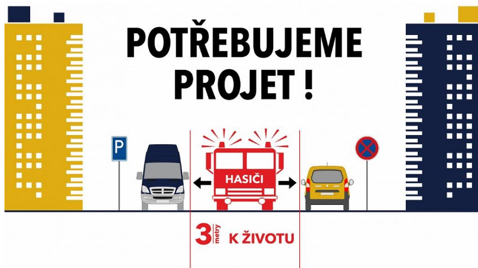
Obrázek 1: Šířka přístupové komunikace. Zdroj: [11]
