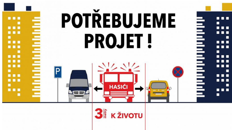
Obrázek 1: Šířka přístupové komunikace. Zdroj: [11]
