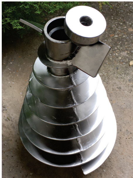
Obr. 1.2: Míchadlo, fotodokumentace ÚPI VUT
