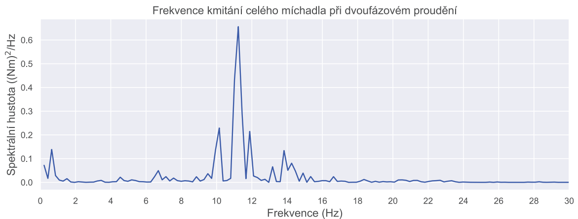
Obr. 5.14: Frekvence momentu působícího na celé míchadlo při dvofázové simulaci.
