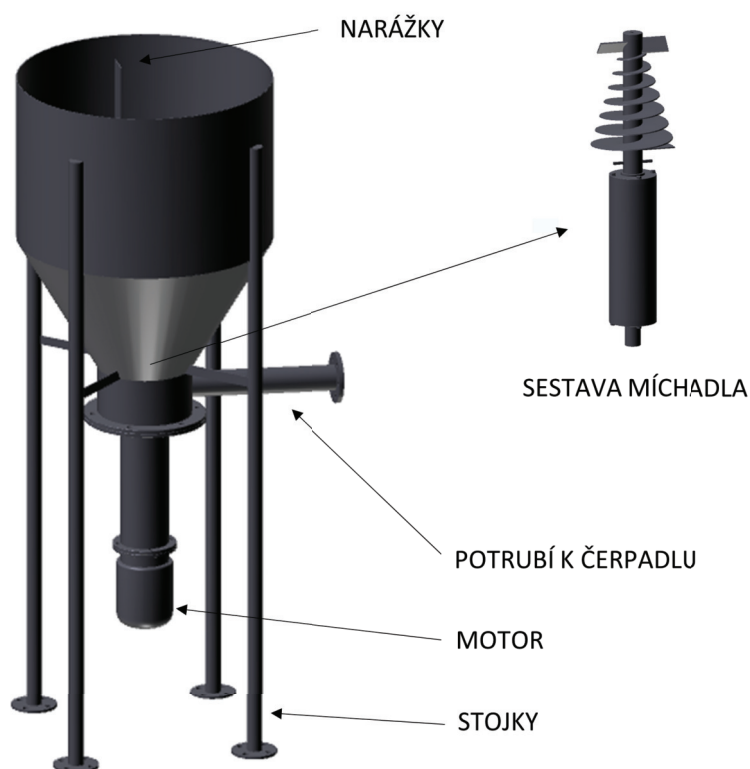
Obr. 5.1: Schematický popis řešené geometrie, upraveno z 3D designu, který vznikl v rámci projektu ÚPI
