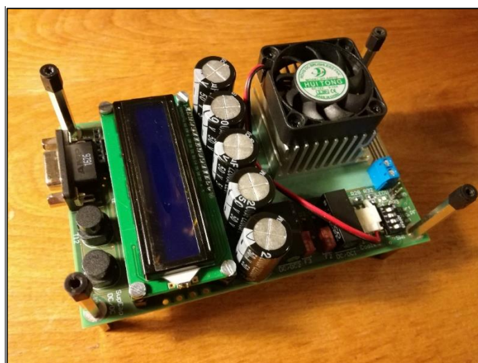
Obrázek 2.2: DPS celkového zařízení DC/DC měniče
