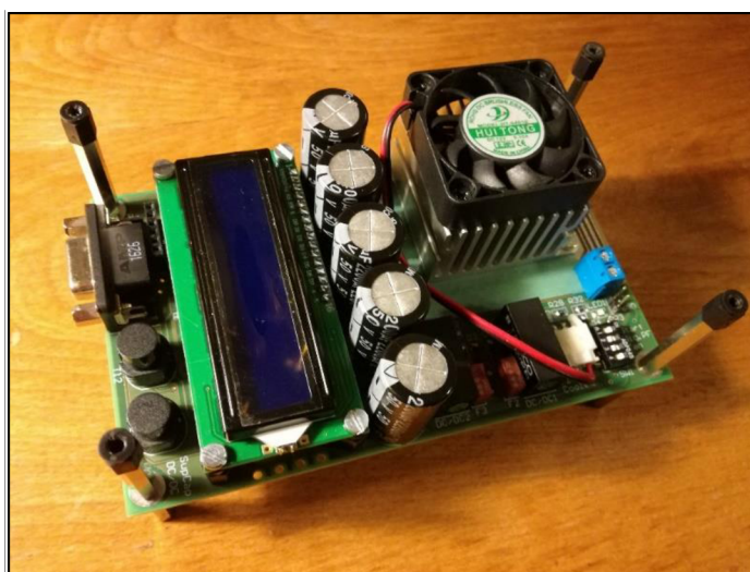
Obrázek 2.2: DPS celkového zařízení DC/DC měniče
