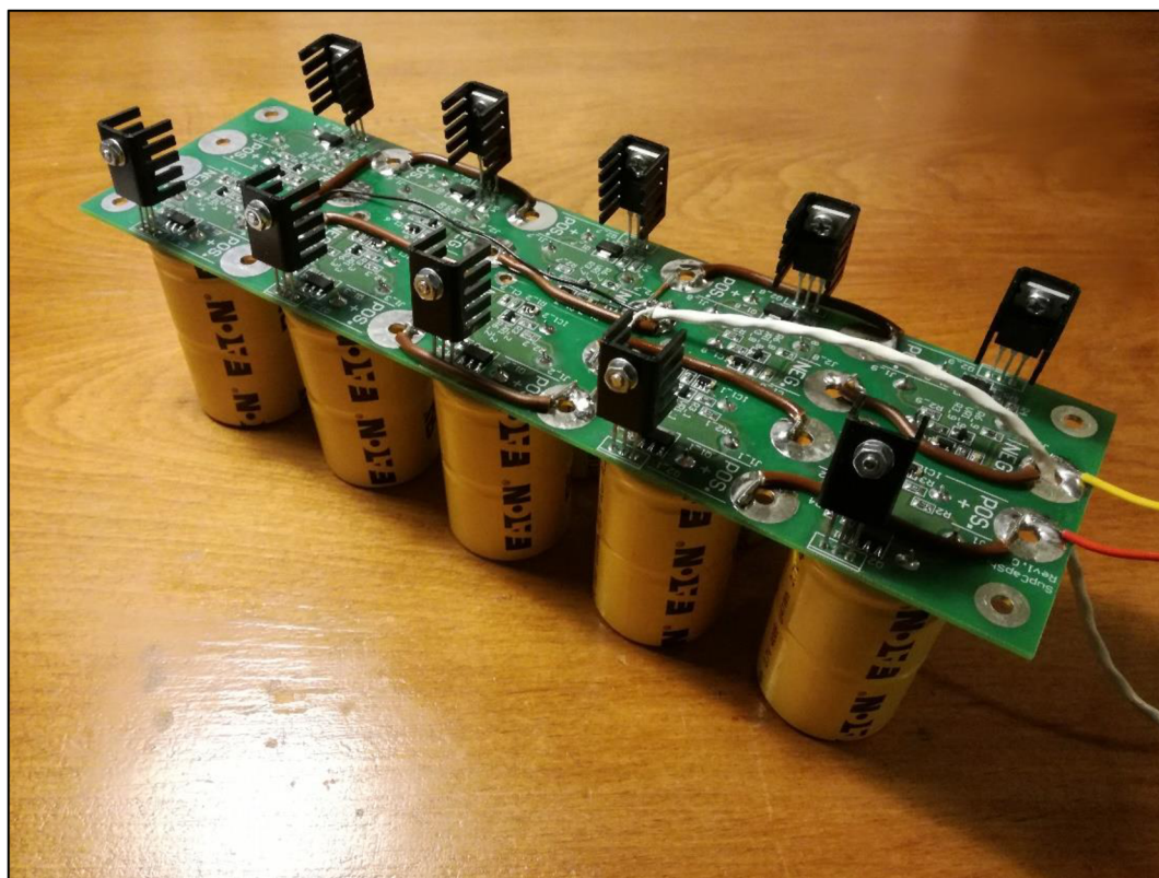
Obrázek 2.3: DPS superkapacitorové banky
