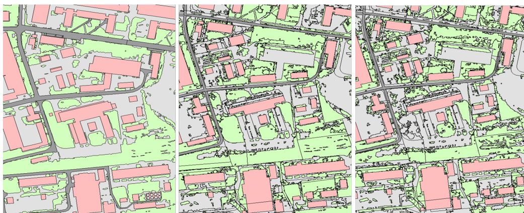
Obrázek 7: Automatická kategorizace s různě volenými prahovými hodnotami NDVI vytvořená v prostředí GONEW
