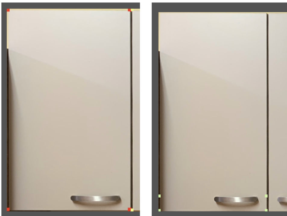
Obrázek 5.3: Porovnání úspěšného a neúspěšného nalezení rohů objektu.
