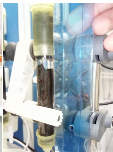
Obr. č. 12, Obr. č. 13: Zakládání a příprava nových kolon s AMOcharem s předem stanovenou váhou adsorbentu a výškou lože.
