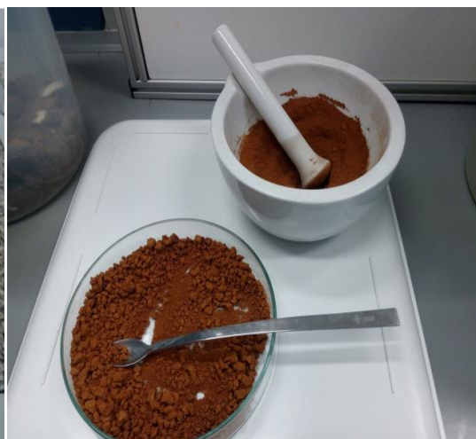
Obr. č. 10, Obr. č. 11: Problematická hydrofobní charakteristika adsorbentu Fe-kal byla řešena přidáním jemného křemičitého písku.
