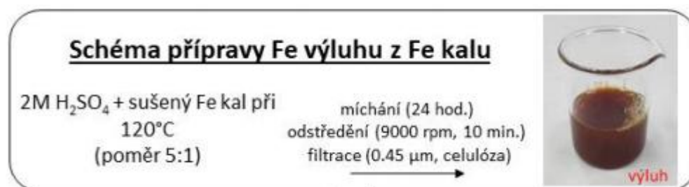
Obr. č. 6: Upravené schéma přípravy železitého kalu pro modifikace LDH s biocharem, certifikované metodika Veselská et al., (2019)
