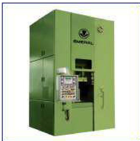
Obr. 2: Kolenový razicí lis s jmen. tvářecí silou 2500 kN firmy Šmeral Brno a.s.
