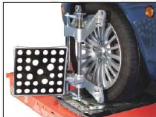
Obr. 3.5 zrkadlový terč uchytaný na prednom kolese - prevzaté z [12]
