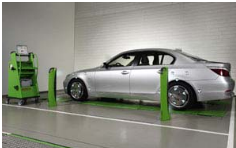
Obr. 3.8 Ukážka práce bezdotykovej geometrie BOSCH LUCHS - prevzaté z [14]
