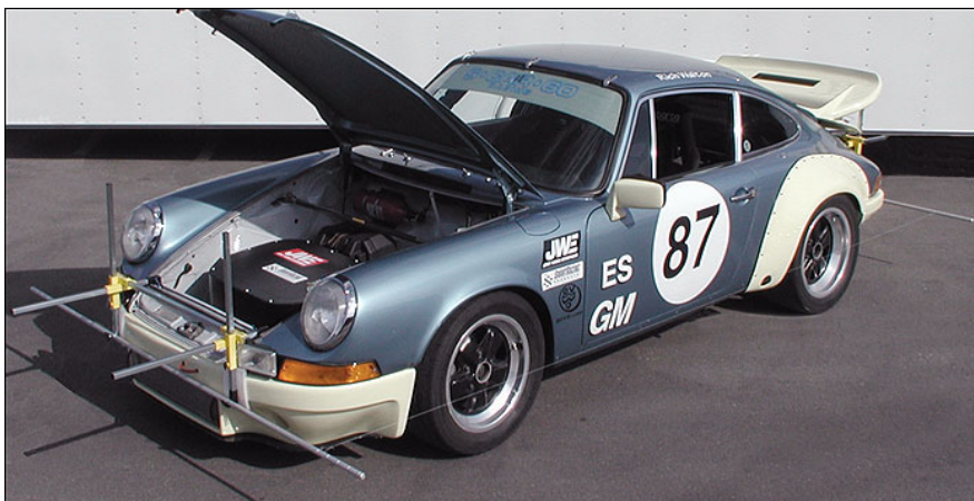
Obr.3.12 Ukážka použitia povrazovej metódy – prevzaté z [18]
