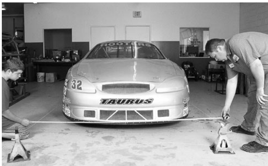
Obr. 3.13 Ukážka použitia povrazovej metódy – prevzaté z [19]
